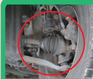
ドライブシャフト のジョイント部 & ベアリング
